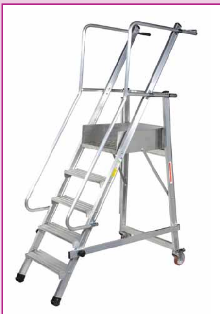
ART. 230 SCALA A CASTELLO PIEGHEVOLE Struttura in trafilato rettangolare in duralluminio e mancorrenzi in tubo tondo, gradini rigati antiscivolo da mm 150 inclinazione 60°, ripiano in lastra mandorlata, 2 ruote da \varnothing 125, piedini in gomma antiscivolo.
