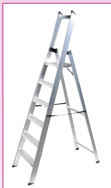
ART. 230 SCALA A CASTELLO PIEGHEVOLE Struttura in trafilato rettangolare in duralluminio e mancorrenzi in tubo tondo, gradini rigati antiscivolo da mm 150 inclinazione 60°, ripiano in lastra mandorlata, 2 ruote da \varnothing 125, piedini in gomma antiscivolo.
